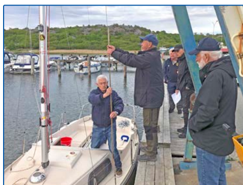
Mats och Kent sätter an yttervantet med tumstocksmetoden
